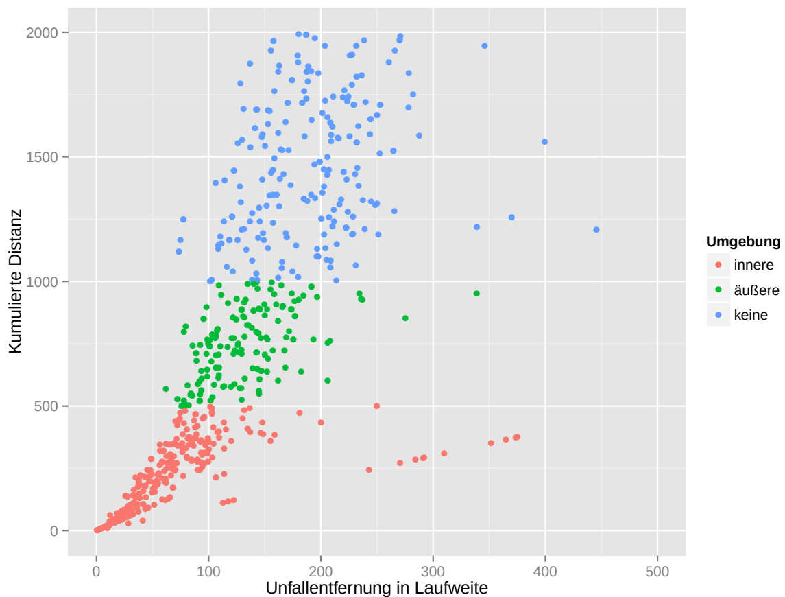
Abbildung 9: Ausschnitt aus den Ergebnissen der Distanzberechnung der Unfälle für eine Stichprobe von 500 Straßensegmenten. Es fehlen die Einträge mit größeren Werten auf den Achsen.
